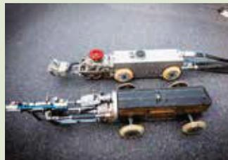
Fräsaufsätze für den KA-TE-Roboter
