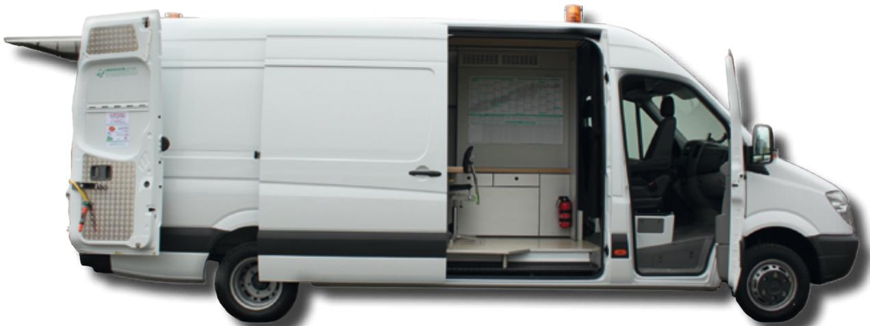
KFZ mit zulässigem Gesamtgewicht von 5,0 to mit Beifahrerdrehsitz und Schwenktüren 270°
