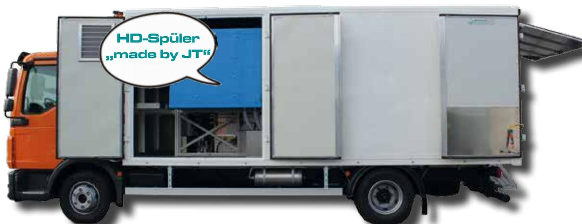
Großzügiger Zugang zur HD-Technik. Stauraum, elektr. Befüllhaspel, Sicherheitstechnik und Zubehör.
