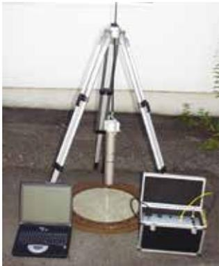
Die hochpräzise Messtechnik zur Schacht- und Abscheiderprüfung. Mit den speziellen Differenzdruckgebern wird die geforderte Genauigkeit mit LGA-Prüfzeugnis wesentlich unterschritten.
