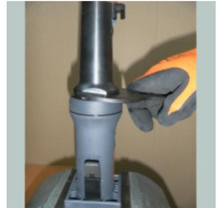
Druckluftschneider mit Schraubenschlüssel aus dem Zubehör in Uhrzeigerrichtung aufschrauben.
