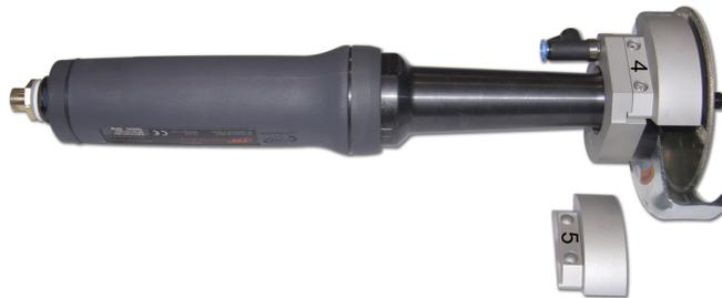
Für den Rückschnitt des Liners ist ein Druckluftschneidgerät erforderlich.
