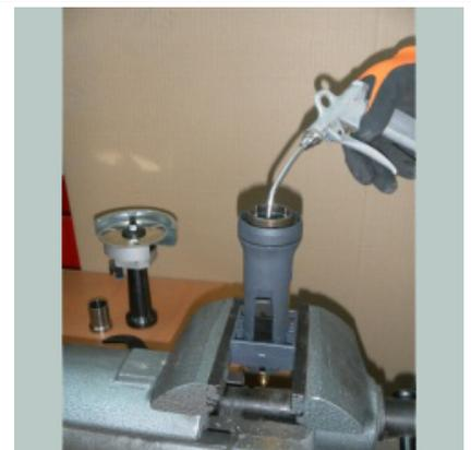
Gehäuse und Druckluftmotor mit Druckluft ausblasen.
