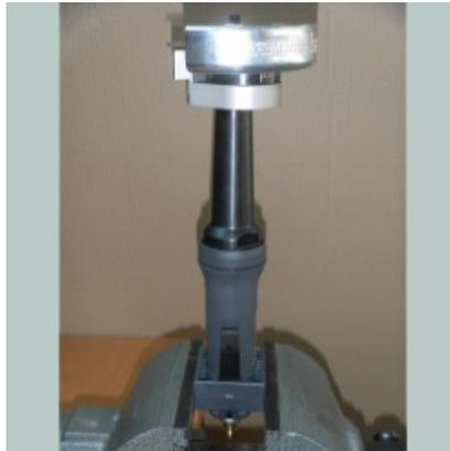
Werkzeug in die Aufnahmevorrichtung spannen.
