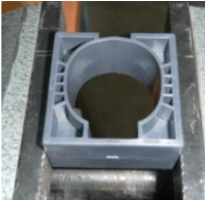
Aufnahmevorrichtung für den Druckluftschneider in den Schraubstock einspannen.
