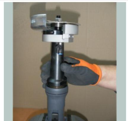
Druckluftschneidergerät zusammenbauen und handfest mit Schraubenschlüssel anziehen.
