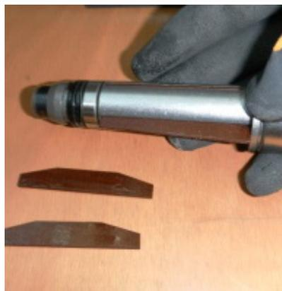
Lamellen aus dem Luftmotor rausziehen.
